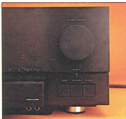
I selettori di ingresso e di uscita agiscono attraverso una logica di comando. Lo stato dei comandi è indicato da una serie di led visibili anche a cassetto chiuso.
