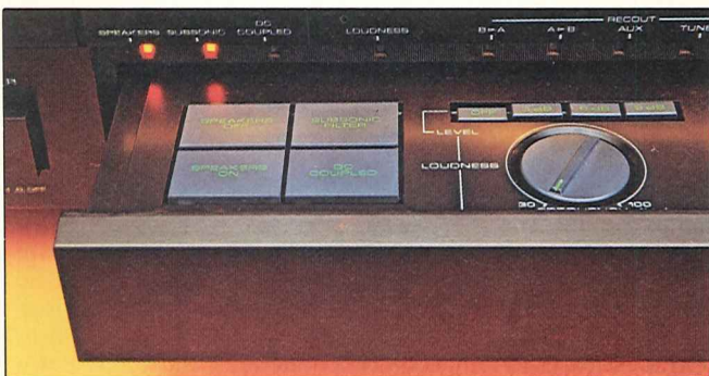
I selettori di ingresso e di uscita agiscono attraverso una logica di comando. Lo stato dei comandi è indicato da una serie di led visibili anche a cassetto chiuso.
